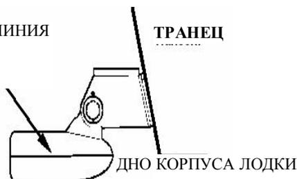
В большинстве случаев датчик надо устанавливать так, чтобы его центральная линия была на уровне низа корпуса лодки. Такое положение обеспечивает плавный ток воды и защиту от ударов и столкновений
