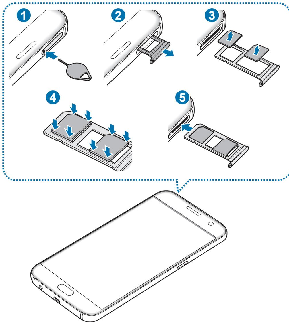
1 Вставьте штифт для извлечения в отверстие слота, чтобы ослабить его.
