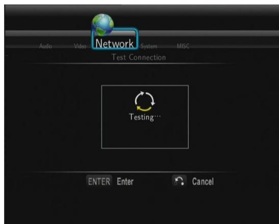
Тестирование может занять продолжительное время, подождите окончания процесса. Если тест прошел успешно, информация о сети (Profile Name, IP address, Subnet Mask, Gateway и т.д.) отобразятся на экране.
