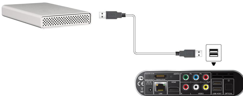
При таком подключении Вы можете просматривать содержимое устройства USB.
