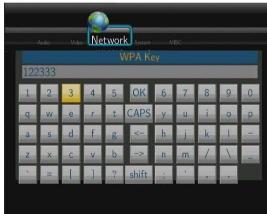
Ключи шифрования вводятся с помощью виртуальной клавиатуры. Используйте навигационные клавиши для выбора, кнопку **ENTER** для ввода, **CAPS** для переключения регистра, <- для удаления символа -> для ввода пробела, **shift** для использования дополнительных символов, **OK** для подтверждения.
