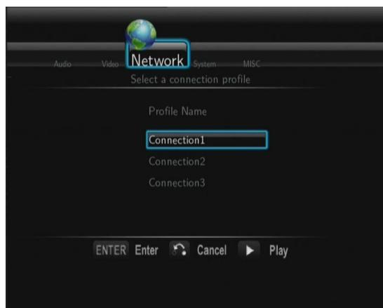
Этот плеер может сохранять до 3 профилей беспроводных соединений. Нажмите **ENTER** для перехода к следующему шагу, нажмите **RETURN** для отмены или нажмите **PLAY** для установки связи.
