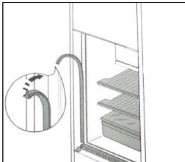
3) Прижмите холодильник к стенке шкафа со стороны, где установлен уплотнитель, и зафиксируйте корпус холодильника 6-ю винтами, идущими в комплекте поставки. Установите вентиляционную решетку “С” (если поставляется) и декоративную заглушку петли “D”.
