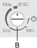
Для включения функции «Быстрое замораживание» установите ручку В так, чтобы знак треугольника на ручке был в положении **SF/SC**.
