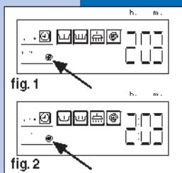
В стиральной машине предусмотрен широкий выбор скоростей отжима, которые устанавливаются в соответствии с выбранной программой перед ее пуском. Для изменения скорости отжима достаточно просто нажать кнопку (Н) до достижения требуемого значения (рис. 1); при желании исключить отжим нажмите кнопку, пока на дисплее остается символ отжима и надпись "00" (рис. 2).
