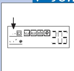
Машина располагает функцией, позволяющей отложить процесс стирки максимум на 16 часов. При каждом нажатии кнопки (L) на дисплее появляется час от 1 до 16, соответствующий времени ожидания начала цикла. После нажатия кнопки (L) стиральная машина ждет введенное в программу количество часов задержки, а затем автоматически начинает цикл стирки.
