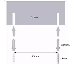
3. Вытащите базу/зарядное устройство из стойки и совместите отверстия на задней поверхности базы с головками винтов, затем осторожно потяните базу вниз, чтобы надежно закрепить ее на стене.
