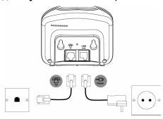
Подключите главный кабель питания к гнезду, обозначенному — на нижней стороне базовой станции, воткните штепсель на другом конце кабеля в настенную розетку и включите питание.
