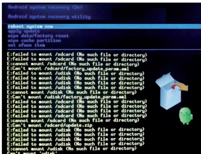
4. С помощью кнопок ▲▼ на ПДУ выберите строку **"wipe data/factory reset"** и нажмите кнопку **ENTER**.
