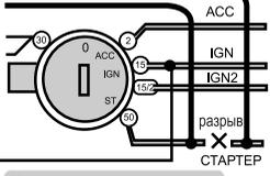
Использование встраенного реле в режиме блокировки линии стартер
