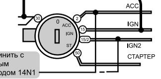
соединить с желтым проводом 14N1
