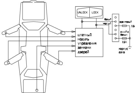
**Трехпроводная цепь отпирания/запирания дверей положительной полярности (большинство легковых автомобилей «Дженерал Моторс»)**
