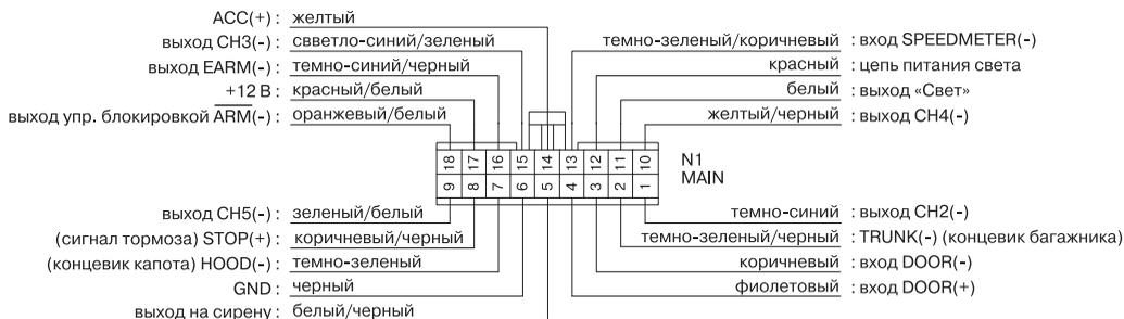
1 — канал CH2 (темно-синий провод). Выход второго канала CH2. Выход управления по каналу CH2 представляет собой слаботочный выход 500 мА, поэтому он должен использоваться только для включения внешнего реле или эквивалентной нагрузки. Второй канал активируется согласно выбранной функции F27 таблицы программирования.
