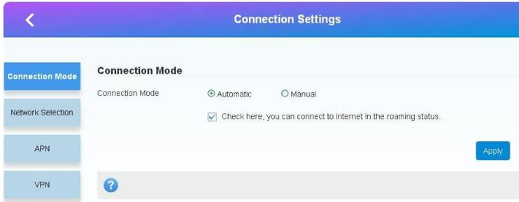
Вы можете выбрать тип подключения к интернету – Автоматически(Automatic) или Вручную(Manual). Так же можете установить галочку для использования в роуминге. По умолчанию – Автоматически.
