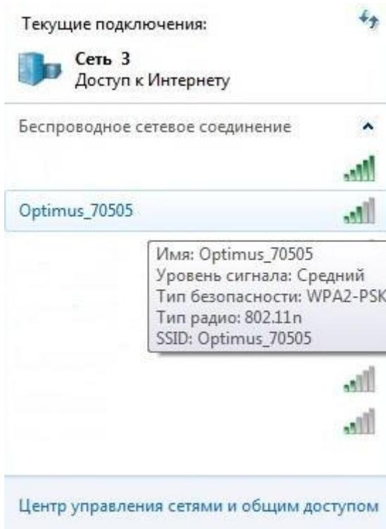
Подключаем собранную камеру к питанию 12В постоянного тока. С помощью ПК ищем Wi-Fi сеть «Optimus\_XXXXX», где XXXXX – последние цифры P2P ID номера.
