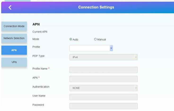
APN – настройка точки доступа. Если модем автоматически не настроил сеть с вашей Sim-картой, вы можете сделать это вручную, используя данные от вашего оператора сотовой связи. По умолчанию – Автоматически.
