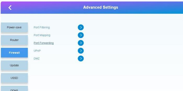
Если используется статический IP адрес выхода в интернет, можно настроить перенаправление портов для доступа к самой камере.
