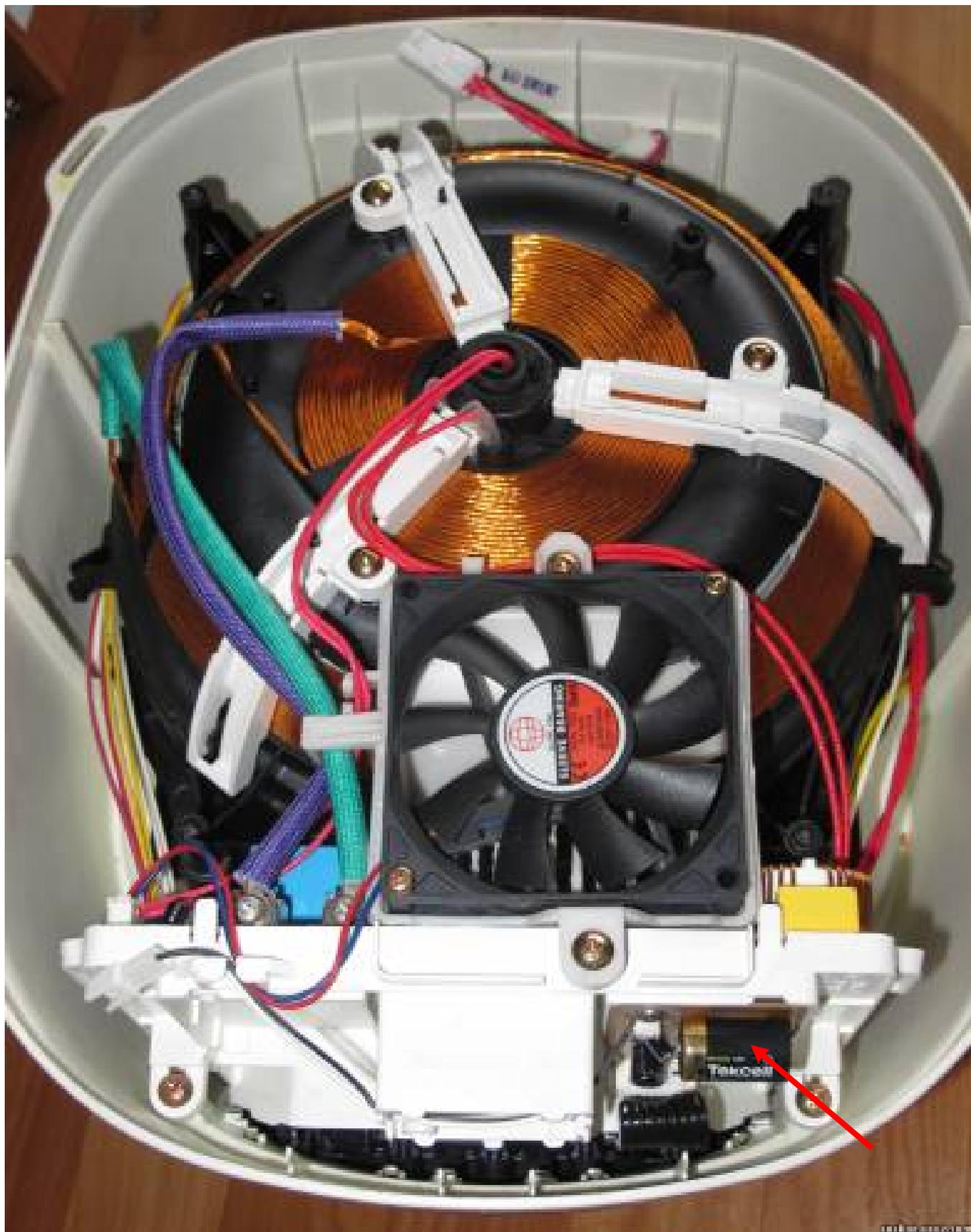
Обмотки медного провода (оранжевая круглая конструкция) - это и есть та движущая сила, что
