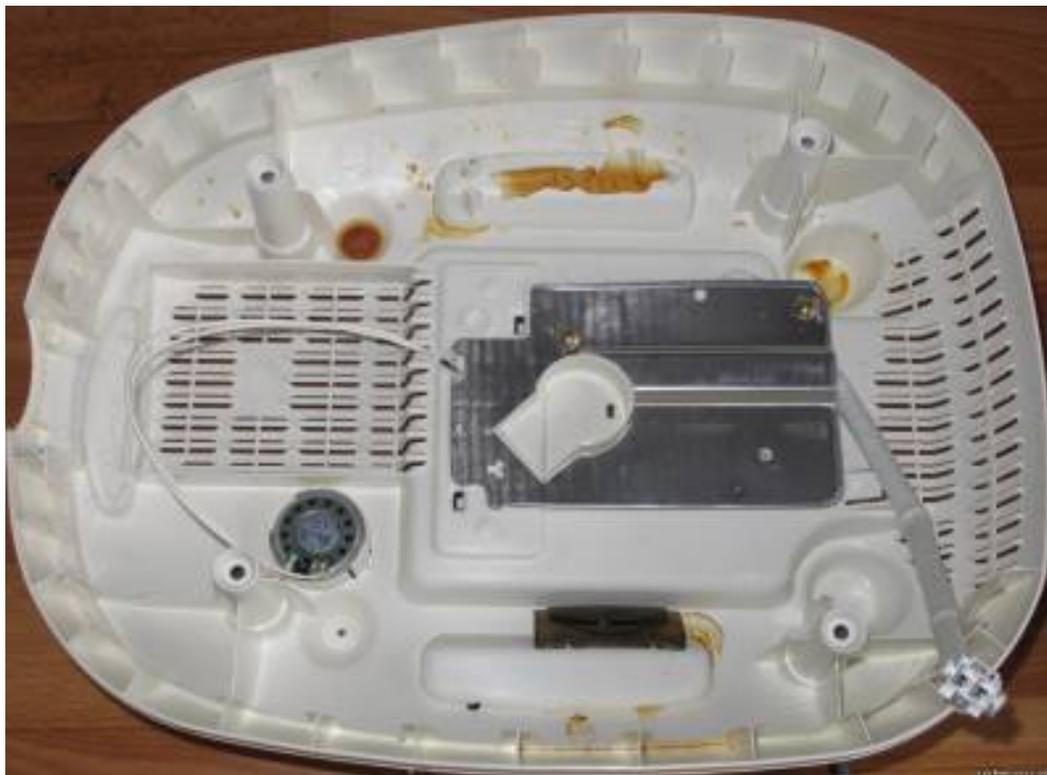
Плату с аккумулятором легко снять, открутив два самореза, но перед этим весь блок (белый пластмассовый, к которому плата приручена) придется осторожно приподнять (открутив 2 самореза). При этом кнопки управления, находящиеся ниже, будут задевать о корпус при перемещении блока, будьте осторожны.
