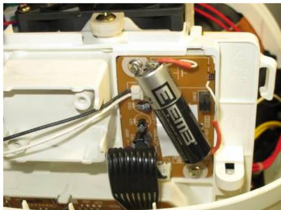
2). Аккумулятор 18650 по размеру еще больше, его пришлось разместить снизу закрепив резинкой. При заказе батареи в магазине <https://www.chipdip.ru> решил заказать более удобную для установки и пайки батарею и гораздо большей емкостью - 3.65 Ah против 1.2 Ah:
