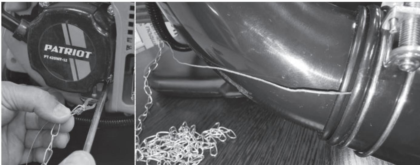
10. На модели распылителя-опрыскивателя PT 420WF-12 закрепите клемму цепочки для сброса статического электричества под винт крепления стартера, а провод заведите в сочленение между гибким напорным рукавом и напорного воздуховода А.
