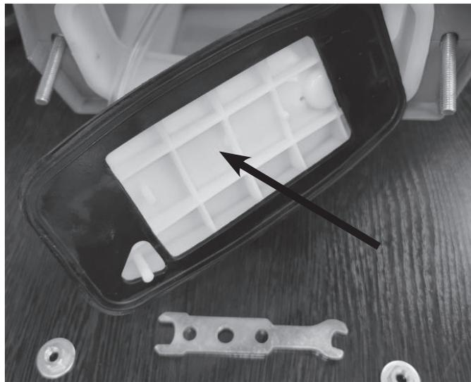
**12.** Отсоедините шланги, снимите с заглушки резиновое уплотнение и переставьте его на дозатор сыпучих химикатов. Затем плотно вставьте дозатор в основание воздуходува, накройте баком и затяните гайки крепления с двух сторон. Обратите внимание на правильность ориентирования дозатора в корпусе воздуходува. Окно дозатора должно быть размещено напротив пластины регулировки подачи химикатов.
