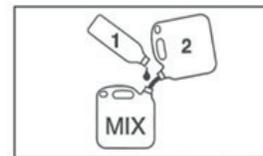
Топливная смесь со временем теряет свои свойства, смешивайте только необходимое количество топлива для требуемого объёма работы. Не допускается оставлять топливную смесь в баке распылителя более чем на 10 дней.
