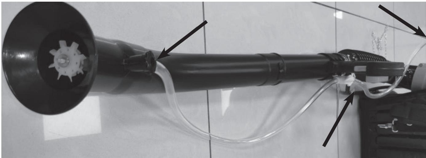
9. Плотно насадите подающие раствор шланги на штуцеры дозатора, запорного крана и бака для химрастворов.
