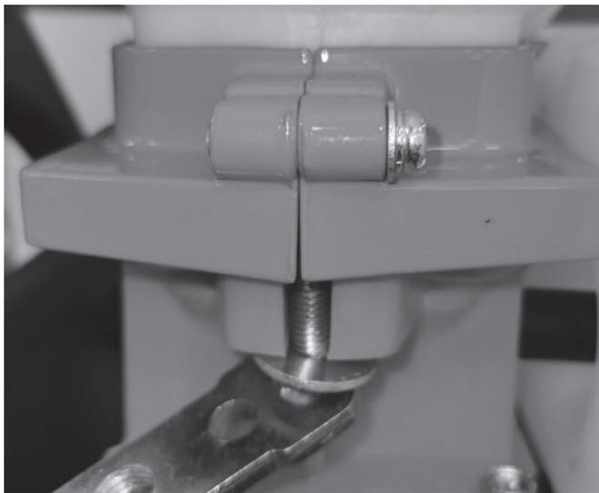
**11.** Для производства работ по распылению сухих химикатов и удобрений необходимо отделить бак для химикатов от корпуса воздуходува, открутив гайки с двух сторон. Затем снять заглушку с нагнетательным шлангом.
