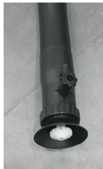
5. Отрегулируйте удобное для работы положение рукоятки управления вдоль напорного воздуховода А и затяните все хомуты.
